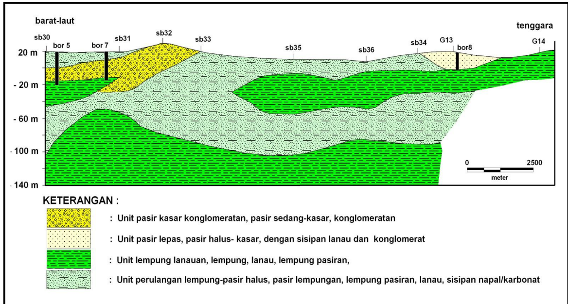
Gambar 10. Penampang geologi Formasi Sajau pada sisi timur Pulau Nunukan
