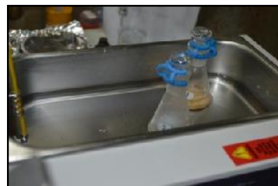
Gambar 2. Proses penyerapan tungstat ke dalam MBZ dengan pemanasan selama 3 jam
