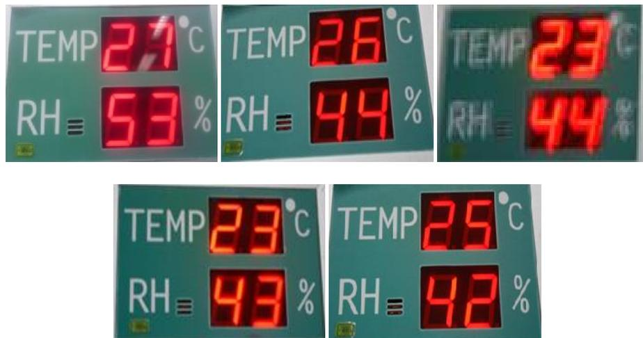
Gambar 5. Pembacaan suhu dan kelembaban pada saat *duct heater* beroperasi selama 1 jam
