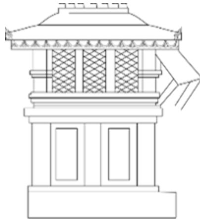
Gambar 27. Bangunan berkonstruksi kayu beratap limasan dengan tambahan kanopi dan ventilasi dinding bermotif pada relief BGB4 I, 18. (Sumber: Setyawan, 2021 )
