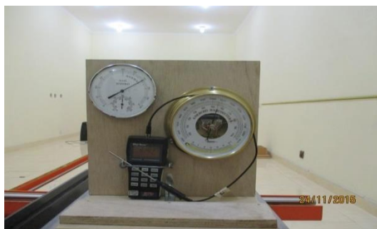
Gambar 4. Alat ukur suhu, tekanan dan kelembaban
