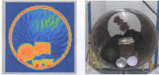
Gambar 14. Citra digital hasil rekonstruksi gamma tomography
