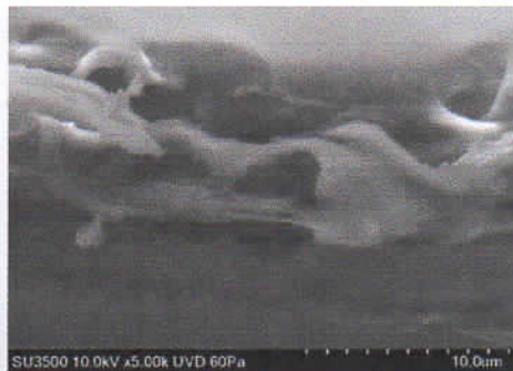
Gambar 4b Fotograp SEM film ETFE-g-St.
