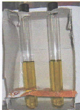
Gambar 1. Sampel film ETFE terendam dalam toluen untuk iradiasi
