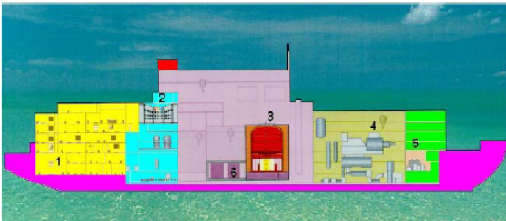
Gambar 4 Tata letak (Layout) kompartemen di dalam tongkang PLTN terapung berbasis KLT-40s yang terdiri dari kompartemen hunian (1), ruang kendali utama (2), kompartemen reaktor (3), kompartemen turbin (4), kompartemen kelistrikan (6) [2]
