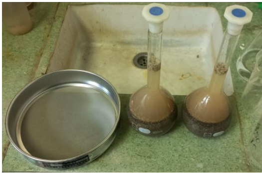
Gambar 5. Salah Satu Langkah dalam Pengukuran Berat Jenis Agregat Halus (Pasir) IPLN
