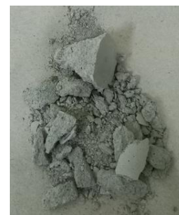
Gambar 12. Bentuk Kehancuran/ Keruntuhan Pada Salah Satu Benda Uji Mortar
