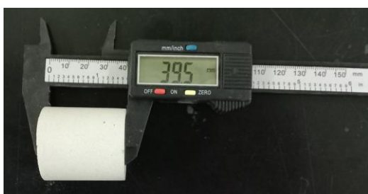
Gambar 10. Contoh Pengukuran Ketinggian Benda Uji Mortar
