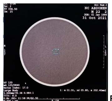
Gambar 9. Pengukuran noise pada ROI, (A) Pemindaian phantom sebelum kalibrasi dengan protokol Head , dan (B) Pemindaian phantom sebelum kalibrasi dengan protokol Abdomen
