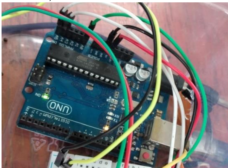
Gambar 5. Lampu indikator Arduino UNO menyala saat program berjalan
