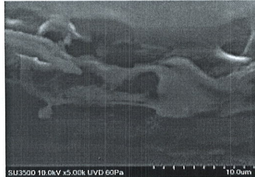
Gambar 4b Fotograp SEM film ETFE-g-St.
