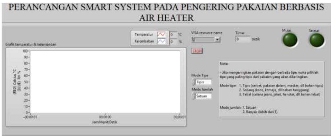
Gambar 3. Tampilan antarmuka prototipe sistem kendali pengering pakaian
