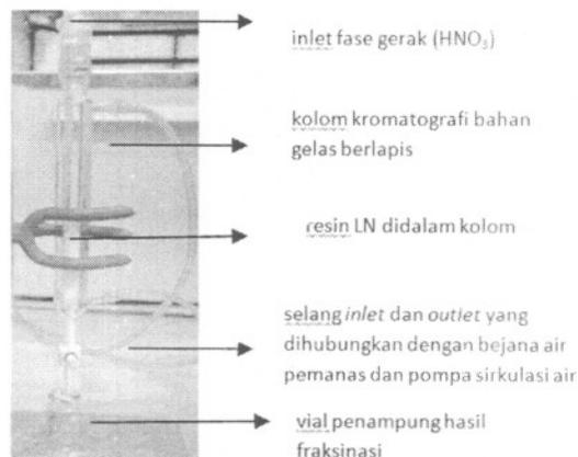
Gambar 3. Rangkaian kolom kromatografi untuk proses pemisahan  $^{177}\text{Lu}$
