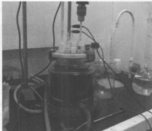
Gambar.2 Percobaan dekontaminasi solven organik (TBP) dengan oksidasi  $Ag^{+2}$
