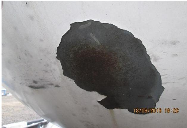
Gambar 6. *Uniform corrosion* pada bagian atas (2)
