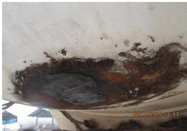
Gambar 5. *Uniform corrosion* pada *head*
