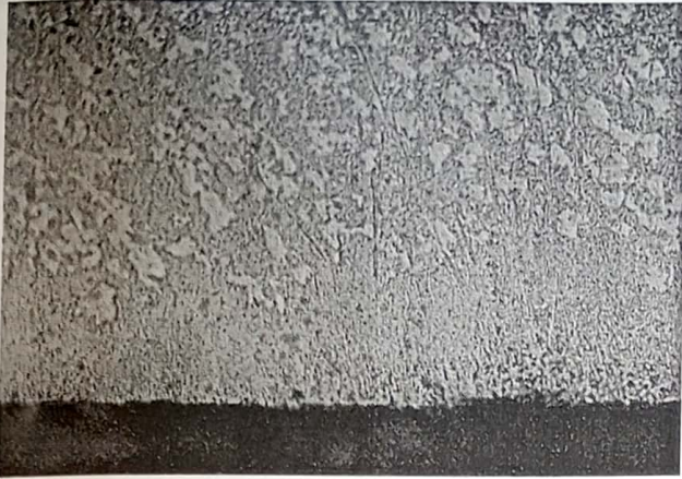
Gambar 14. Nitrocarburizing 650°C Dengan Pembesaran 500x
