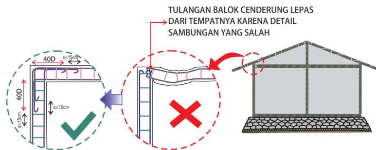
Gambar 5. Bentuk Hubungan Balok-Kolom Yang Disarankan Untuk Bangunan Tahan Gempa (Sumber: Boen (2010))
