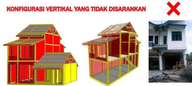
Gambar 4. Bentuk Konfigurasi Vertikal Yang Tidak di Sarankan (Sumber: Boen (2010))
