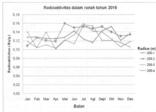
Gambar 8. Radioaktivitas sampel tanah dalam radius 200 m
