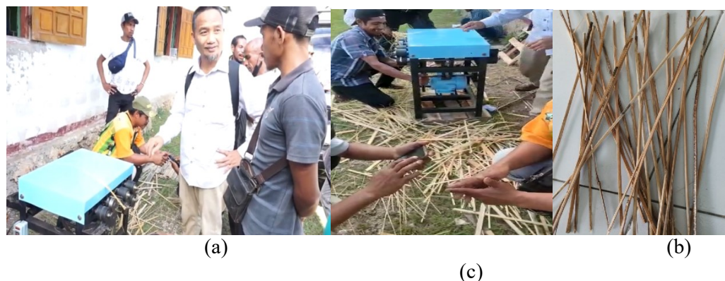
Gambar 3. Penjelasan operasional alat pengirat bambu oleh nara sumber (a), pengoperasian alat (b) dan hasil iratan bambu (c).
