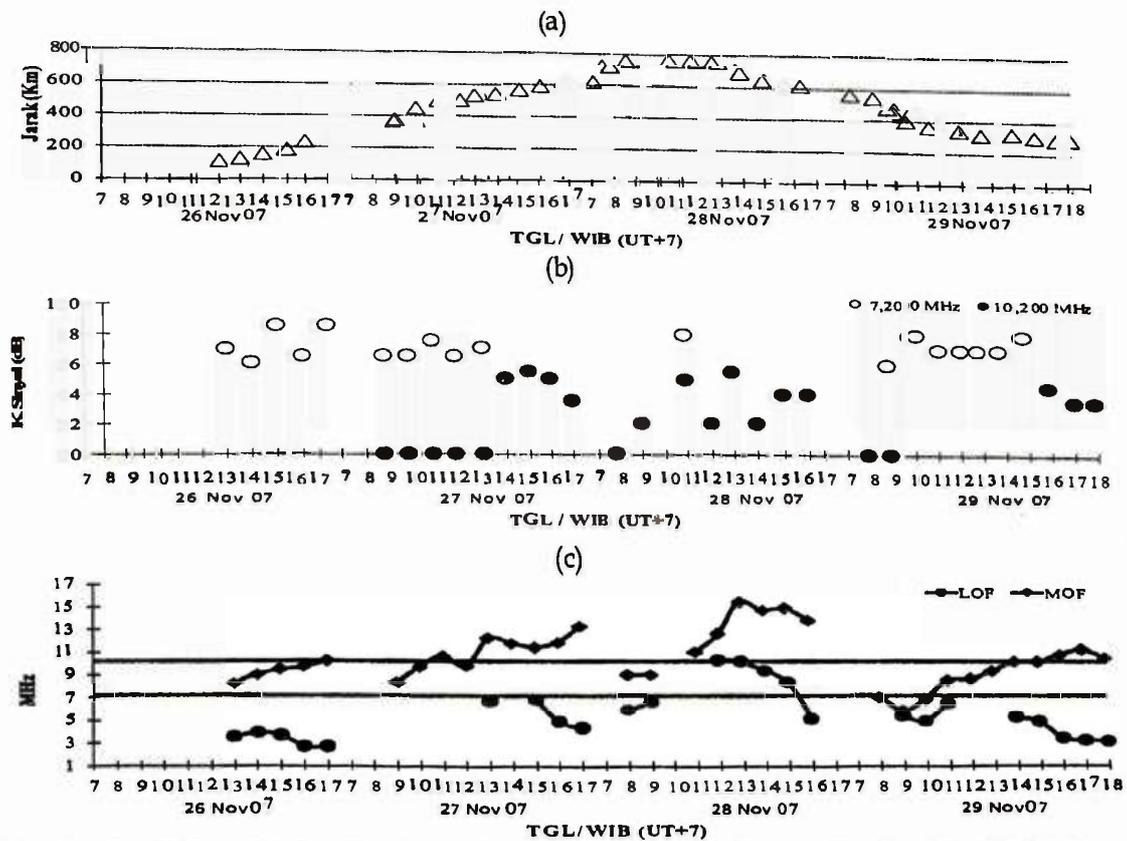
Gambar 4-2: Jarak Rx terhadap Tx di Bandung (a), kuat sinyal yang diterima Rx (b), keduanya hasil pengamatan tanggal 26-29 November 2007, dan frekuensi terendah (LOF) dan frekuensi tertinggi (MOF) untuk setiap jarak komunikasi pada (a) hasil simulasi berdasarkan  $f_{min}$ ,  $f_oF_2$ , dan  $h'F$  hasil pengamatan di SPD Tanjungsari
