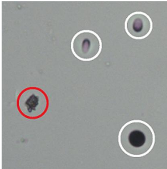
Gambar 5 Hasil pembacaan jejak radon menggunakan mikroskop dengan perbesaran 400x, lingkaran putih adalah jejak dari radon sedangkan lingkaran merah adalah noise .
