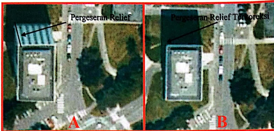
Gambar 2. Citra satelit sebelum dilakukan rektifikasi ortho (A) dan sesudahnya (B)
