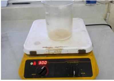
Gambar 2. Sampel air hujan diuapkan di atas hot plate
