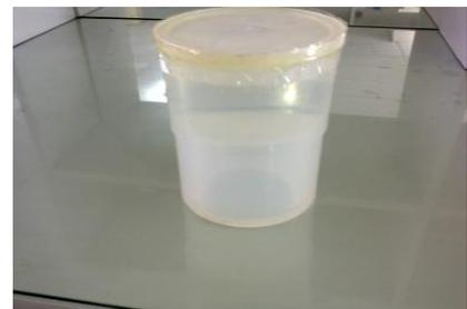
Gambar 6. Sampel air hujan siap diukur dalam beaker Marinelli
