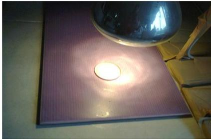
Gambar 3. Sampel air hujan dalam planset diuapkan dibawah lampu IR
