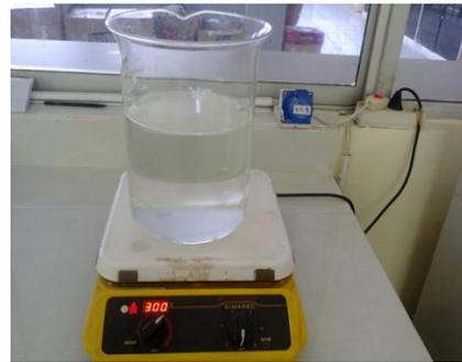
Gambar 5. Sampel air hujan diuapkan dalam beaker glass 5 liter
