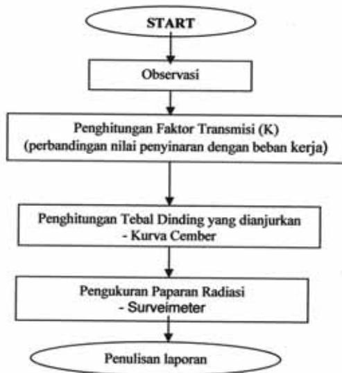
Perhitungan tebal dinding pembatas dilakukan secara teoritis, demikian pula halnya dengan pengukuran paparan radiasi. Data pengukuran laju dosis dilakukan dengan alat *surveymeter* digital jenis Mini 6100/L0000806 dengan
