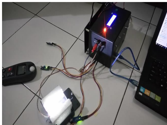
Gambar 4. Pengambilan data nilai ADC telur yang telah dimasukkan ke dalam air
