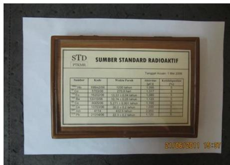
Gambar 6. 1 Set sumber standar untuk spektrometer gamma
