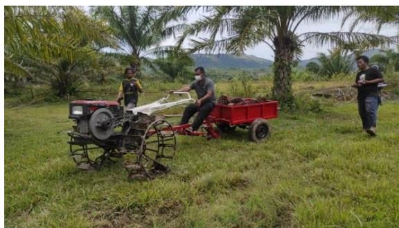
Gambar 1. Pengoperasian traktor menggunakan *trailer tipe pivot II* [1]
