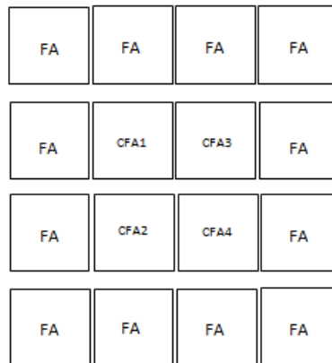
Gambar 3. Susunan bahan bakar dan bahan bakar-kendali dalam teras.
