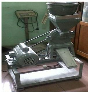
Gambar 13. Alat mekanis untuk pengecilan ukuran biji koro pedang untuk tempe.
