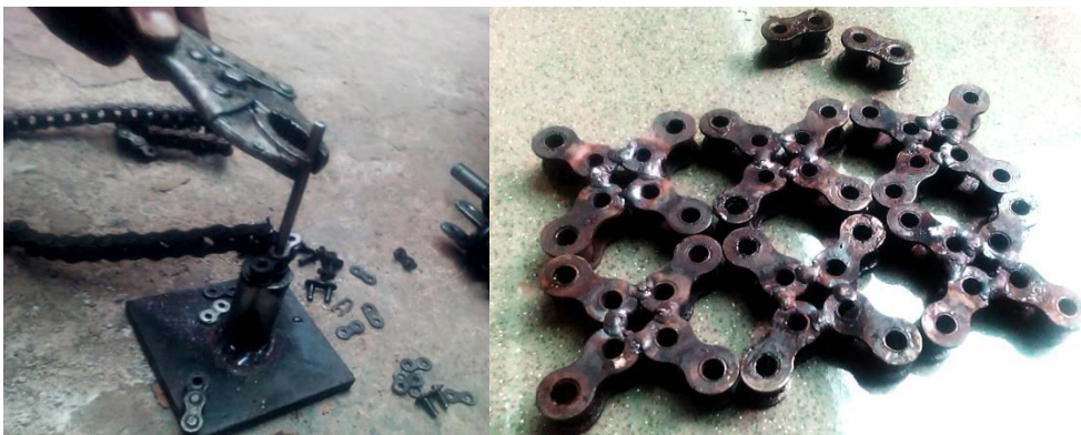
Gambar 13. Proses Pemotongan Mata Rantai & Hasil Akhir Pengelasan Menjadi Ornamen Batik Kawung (Sumber: Dokumentasi Pribadi, 2016)
