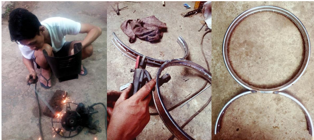
Gambar 11. Proses Pengelasan Bagian-Bagian Meja (Sumber: Dokumentasi Pribadi, 2016)
