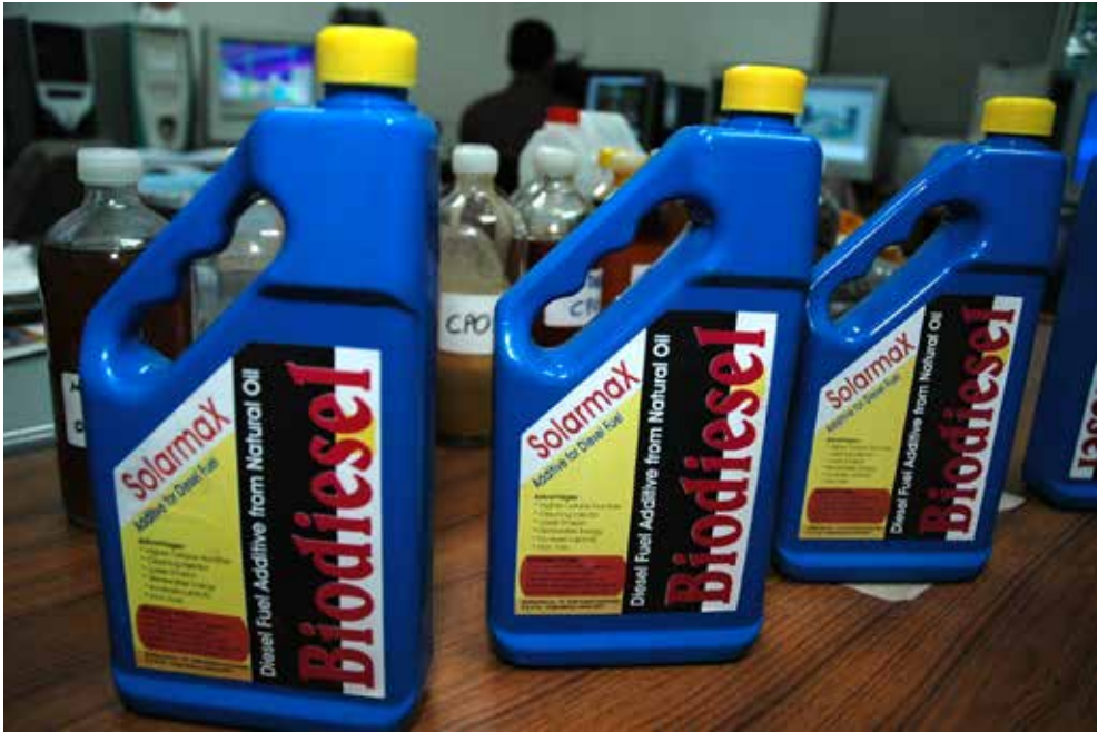
Deretan kemasan bio diesel di Pabrik Bio Diesel BPPT, Serpong, Tangerang, Selasa, 14 Februari 2006. Bio diesel yang terbuat dari minyak tumbuhan, bisa digunakan sebagai bahan bakar tanpa harus memodifikasi mesin karena memiliki sifat fisik dan kimia serupa dengan solar. (TEMPO/ Nickmatulhuda)
