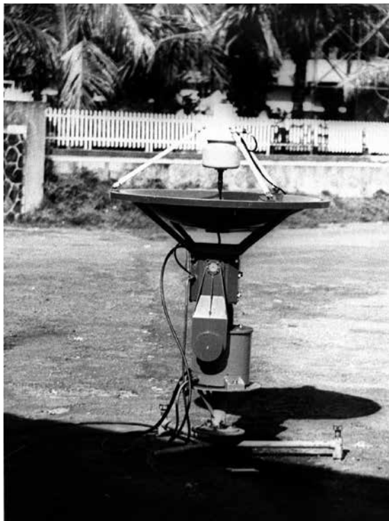
Peralatan Radiosonde untuk mengukur parameter udara atas dalam proses terjadinya hujan buatan yang dilakukan Badan Pengkajian dan Penerapan Teknologi (BPPT), Jakarta, 1987. (REPRO/ BPPT)
