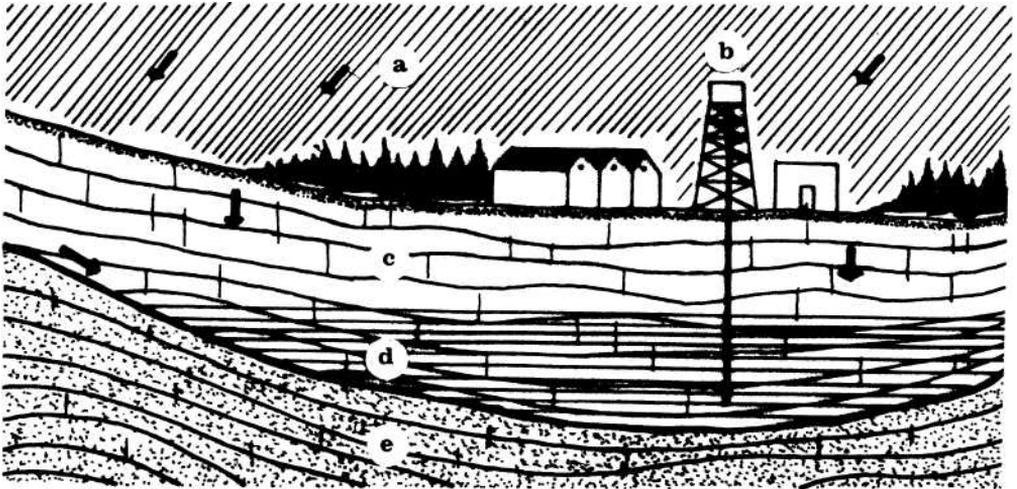
Gambar 2. Proses terbentuknya tandon air di bawah tanah : a, hujan, b. sumur bor, c. lapisan tanah tembus air, d. tandon air di bawah tanah, e. lapisan tanah kedap air (KOGAN 1974).
