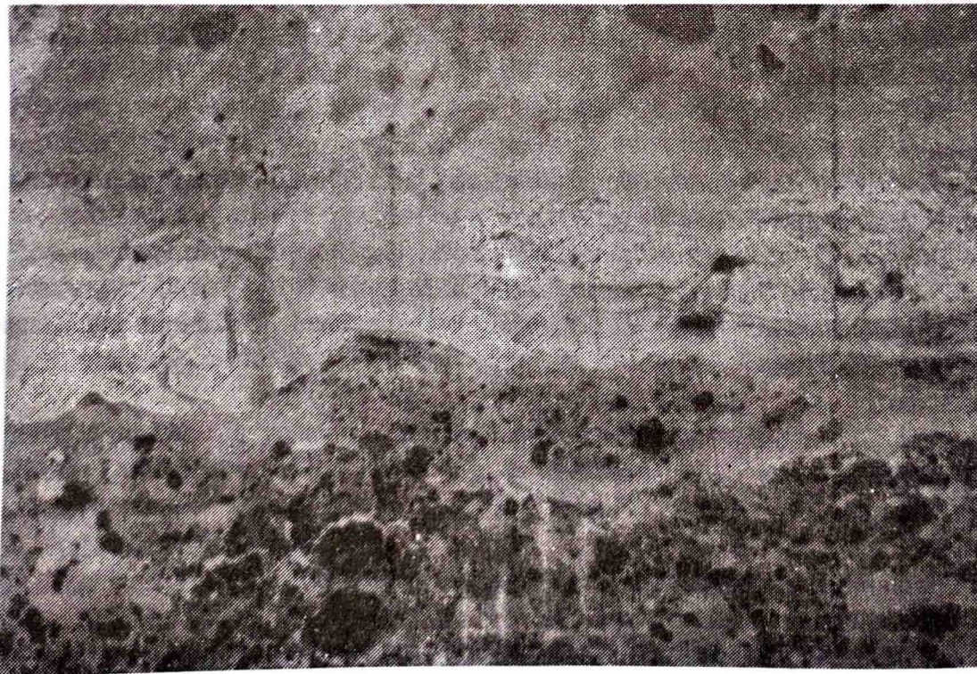
Foto. 2. Mikrostruktur logam yang menunjukkan adanya pola pelapisan yang merupakan hasil proses penempaan.
