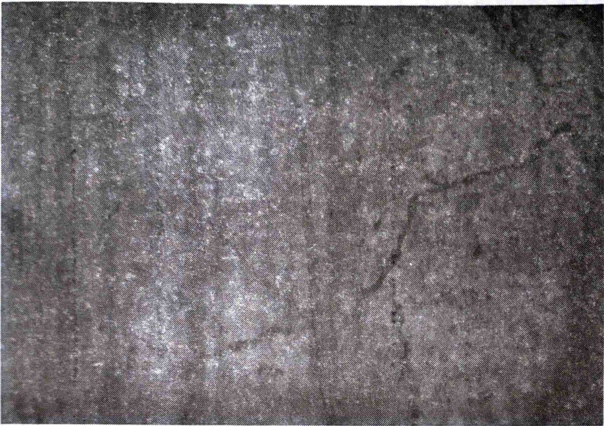
Foto. 3. Alur-alur karat yang terjadi sebagai akibat proses ketegangan dan pemukulan sewaktu masih berfungsi.
