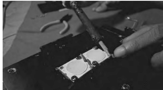
Gambar 12 Perangkaian Lampu LED (Sumber : Dokumen Pribadi)
