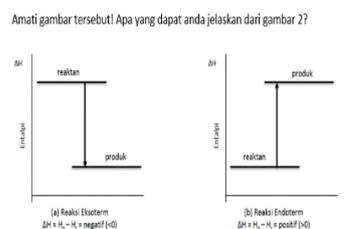
Gambar 2. Diagram Tingkat Energi untuk (a) Reaksi Eksoterm dan (b) Reaksi Endoterm
