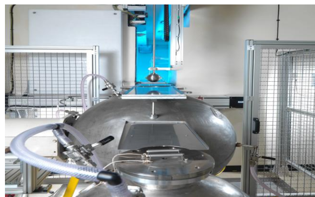
Gambar 5b. Dua bath dan sistem transfer sumber pada sistem manganese bath NPL
