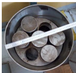
Gambar 3. Tampak atas dan tampak samping drum stainless steel 60 l
