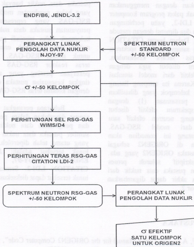
Gambar 2. Diagram alir proses pembangkitan pustaka data nuklir
