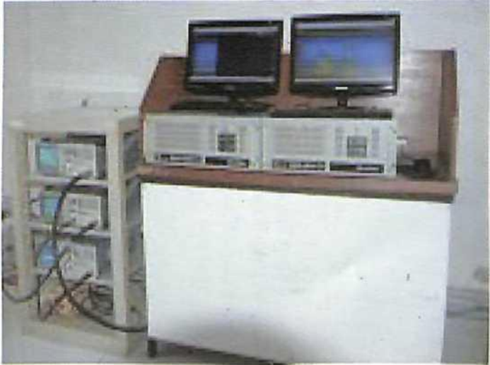
Gambar-33. Spektrograf radio matahari SN4000 setelah dilakukan perbaikan tahun 2009 dan telah dapat beroperasi secara penuh sampai kini (tahun 2014).
