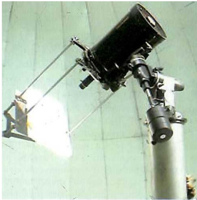
Gambar-31. Teleskop Celestron C8i yang telah dipasang papan proyeksi bayangan matahari untuk menggambar sket sunspot.
