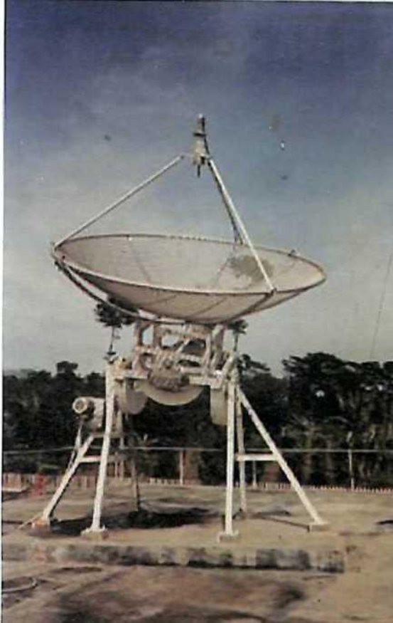
Gambar-14. Antena parabola dengan diameter 2(dua) meter (kiri) dan sistem penerima, pen recorder teleskop radio 606 MHz (kanan).
