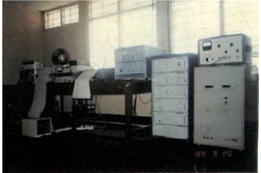
Gambar-14. Antena parabola dengan diameter 2(dua) meter (kiri) dan sistem penerima, pen recorder teleskop radio 606 MHz (kanan).
