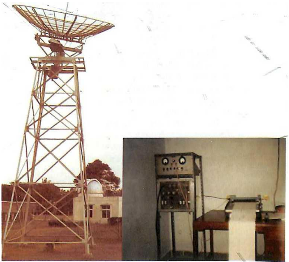
Gambar-9. Teleskop Radio frekuensi 200 MHz. (kiri) Antena parabola diameter 3 meter dengan penyangga setinggi 8 meter, (kanan) Sistem penerima radio frekuensi 200 MHz dengan komponen masih berupa tabung elektronik.
