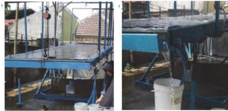
Gambar 1. Alat Uji Simulator Hujan
