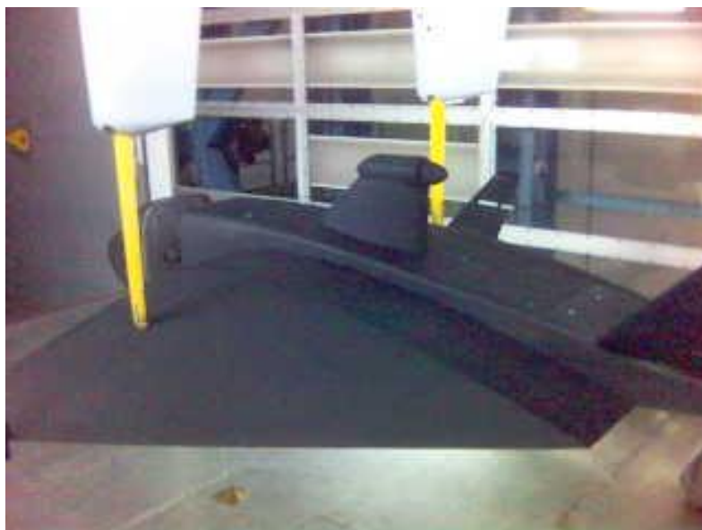
Gambar L7.5 Uji terowongan angin terhadap model 3-D pesawat WISE L8 kapasitas 8 orang (Wijiatmoko et al. , 2006).
