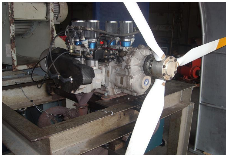
Gambar L1.9 Uji statik gaya propulsi T_s dari daya propulsi EHP sebesar 115.0 HP di BT2MP, Serpong (Syamsuar et al. , 2011).
