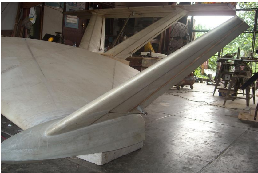
Gambar 1.3 Posisi winglet , sayap utama dan HTP dari prototipe pesawat WISE L8 kapasitas 1 orang.
