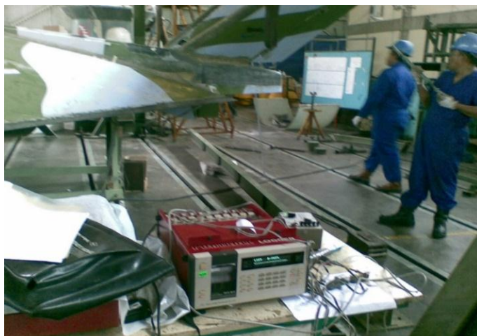
Gambar L1.4 Penimbangan pada prototipe pesawat WISE L8 kapasitas 2 orang dengan alat perekam data.
