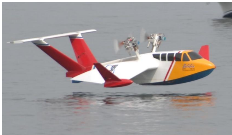
Gambar L1.13 RC model dari pesawat WISE L8 saat terbang stasioner di surface effect .
