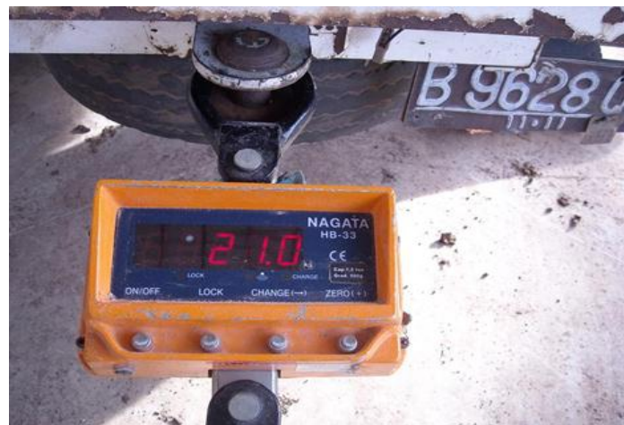
Gambar L1.8 Uji statik gaya propulsi T_s pada prototipe pesawat WISE L8 kapasitas 2 orang yang terletak di atas cradle .
