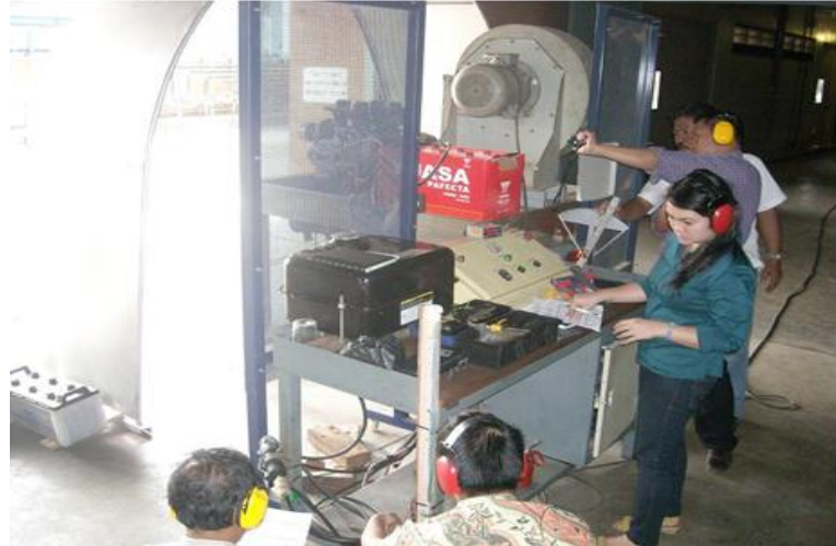
Gambar L1.10 Uji statik gaya propulsi T_s dari daya propulsi EHP \approx 115.0 HP di BT2MP, Serpong.
