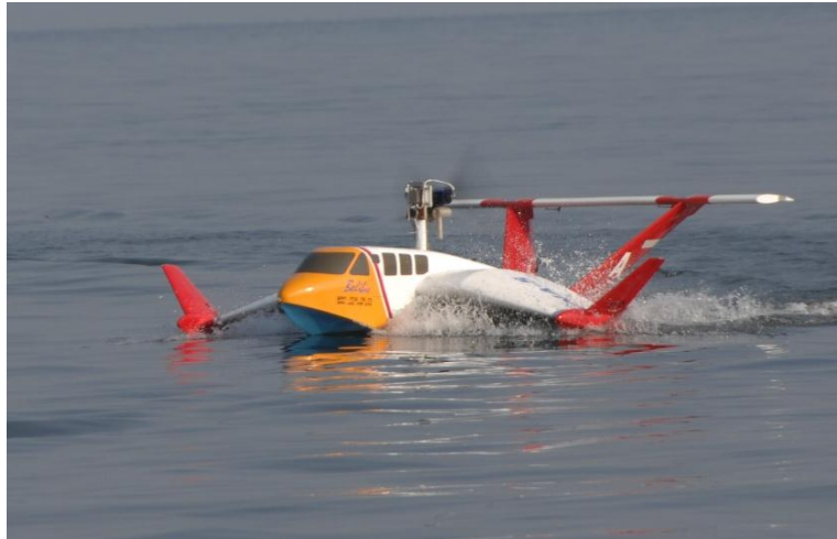
Gambar L1.12 RC model dari pesawat WISE L8 saat high speed water run di mana mulai terjadi porpoising .
