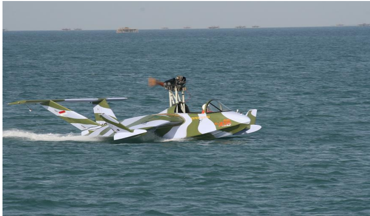
Gambar L1.17 Prototipe Pesawat WISE L8 kapasitas 2 orang saat hydro planing kecepatan V = 32.0 knots.
