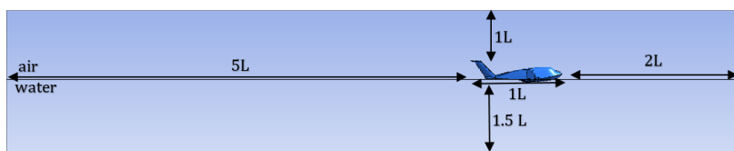
Gambar 4.8 Initial computational domain pada CFD.
