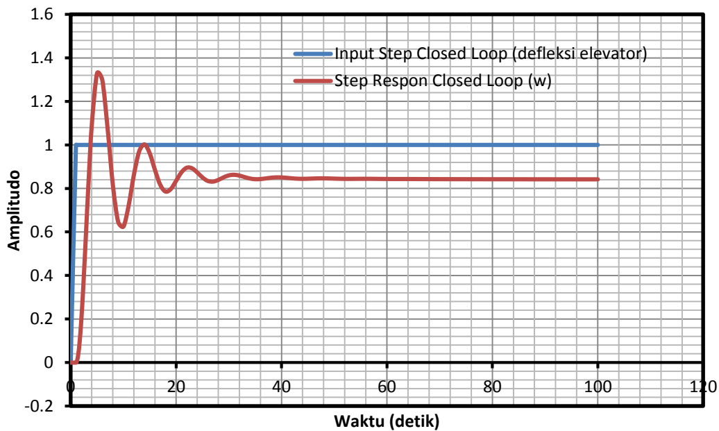
Gambar 5.8 Respons output kecepatan wahana terbang arah normal w terhadap input step , defleksi elevator \delta_e pada sistem lingkaran tertutup.
