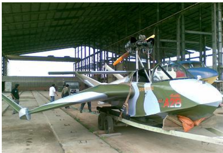
Gambar L1.7 Uji statik gaya propulsi T_s dari prototipe pesawat WISE L8 kapasitas 2 orang pada cradle (Syamsuar, 2015 a).
