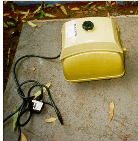
Gambar 8 Bentuk Blower Udara.
