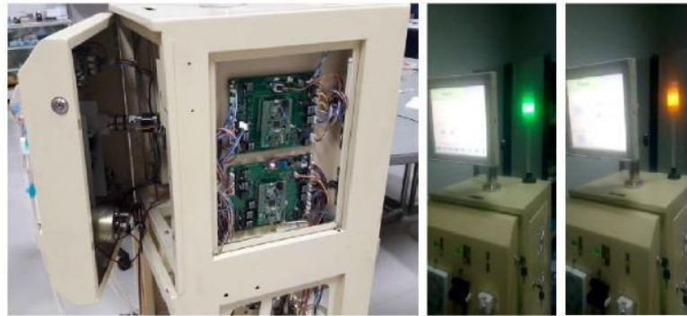
GAMBAR 4. Papan elektronik untuk penanganan sistem alarm dan alarm visual
