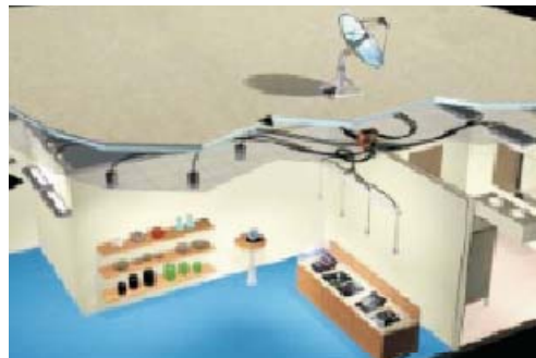
Gambar 5. Instalasi Penerangan Hibrid pada Bangunan
