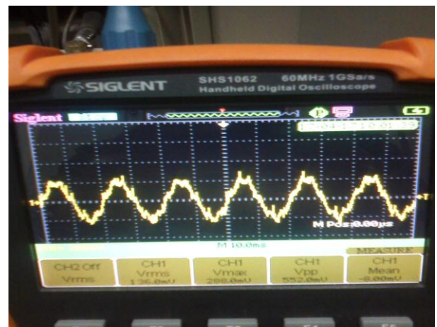
Gambar 4. Gelombang tegangan ripple rectifier BTU22 dengan batere terpasang
