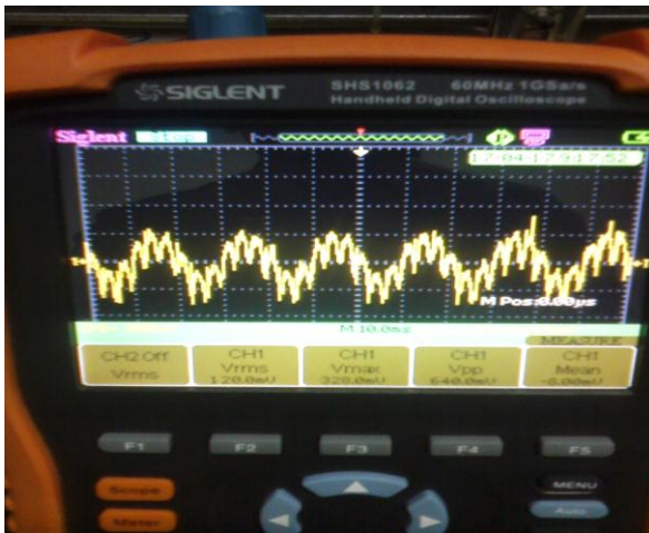
Gambar 2. Gelombang output tegangan rectifier BTU21 dengan batere terpasang
