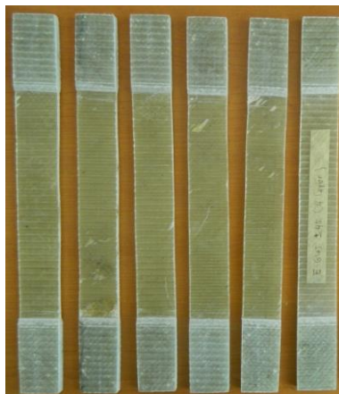
Gambar 3. Spesimen Komposit E-glass \pm 45^\circ + Polyester dengan Vacuum Infusion
