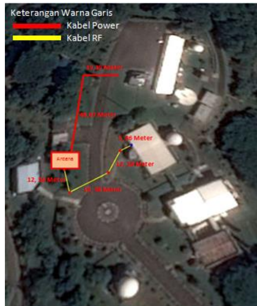
Gambar 11. Rencana alokasi antena X-Band berdiameter untuk akuisisi data VHRSI
