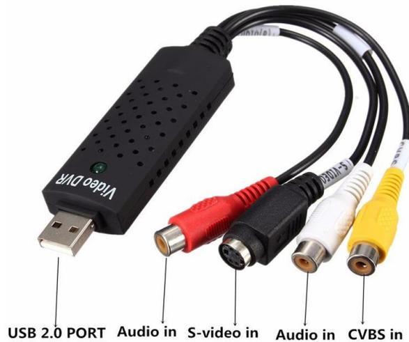
**Gambar 2. Konektor video out to USB untuk menghubungkan kamera dengan laptop**
