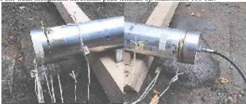
**Gambar 7. Lokasi kebocoran pada tutup benda uji dengan tekanan uji 140 bar [10]**
