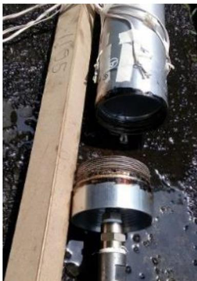
Gambar 1. Sambungan ulir yang rusak pada tekanan uji 127 bar [1]
