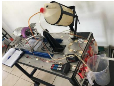
Gambar 12. Benda uji sistem indikator bahan bakar berbasis sensor flowmeter
