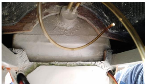
Gambar 10. Penempatan tangki bahan bakar wahana kendali RKX 200 TJ yang menyisakan sedikit ruang untuk menambahkan sistem indikator bahan bakar.
